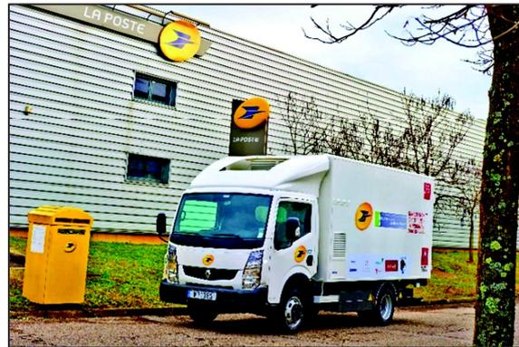
Figura 11: Il camion elettrico dotato di range extender ad idrogeno in fase di testing presso il servizio postale francese
