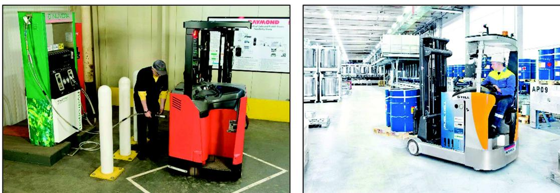
Figura 13: Esempio di carrelli elevatori ad idrogeno operanti in ambiente industriale. A sinistra esempio di stazione di rifornimento.
